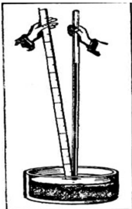
Essa experiência foi repetida por outros sábios em lugares ao nível do mar. E foi verificado que a coluna de mercúrio parava sempre a 30 polegadas de altura, Isso quer dizer que uma coluna de mercúrio de 30 polegadas pesa tanto como uma coluna de ar atmosférico do mesmo diâmetro que vai daqui em baixo até lá no fim do céu.
